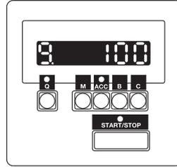
Jeder Tastendruck ändert die direkt oberhalb angezeigte Ziffer (**M** wird für zwei Ziffern benutzt). Links außen wird die Ziffer „9“ angezeigt und gibt an, dass Sie mit einer temporären Stoppstückzahl arbeiten.
